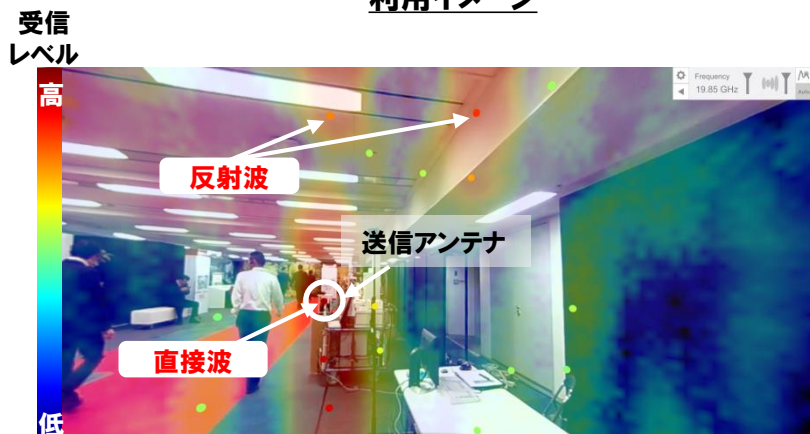
ヘッドマウントディスプレイ観測画面(アンテナ正面方向)
