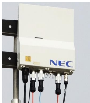
基地局(アンテナ部)
